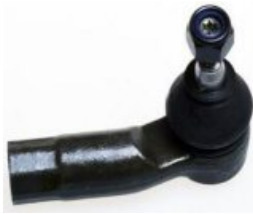
KP-VW-04041 TIE ROD END 1K0 423 812 A L=99 mm T1=M12X 1.5 T2=M16X 1.5 GOLF V
