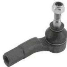
KP-VW-04070 Tie Rod End 6Q0419812C / 6Q0419812D 6Q0423812 / 6Q0423812A 6Q0423812C / 6Q0423812D Polo (9N_) / Polo Stufenh./Sedan
