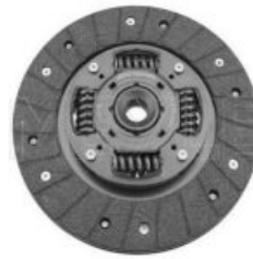
KP-VW-02167 CLUTCH DISC 1861573342 210*140*24*20.7 CORSAR PASSAT
